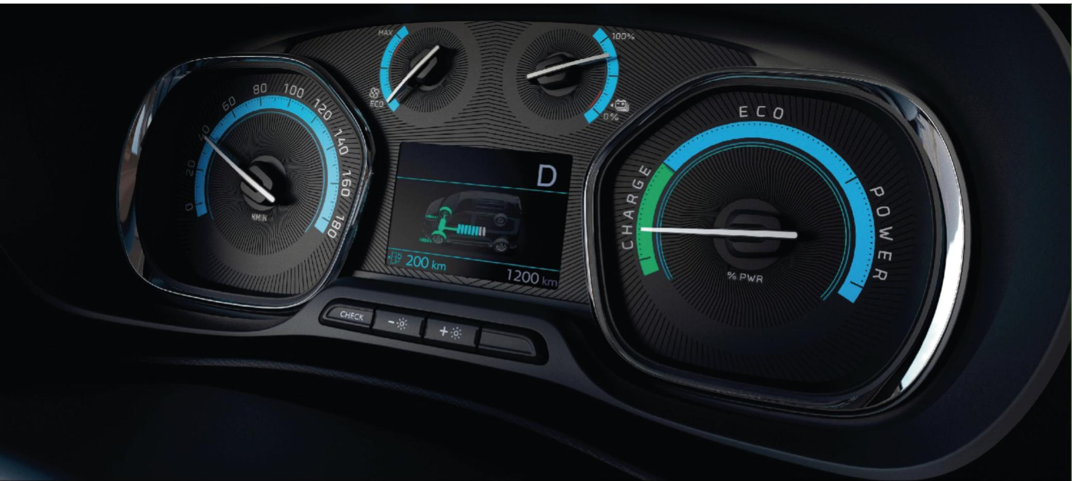
e-CLUSTER: TABLERO DE INSTRUMENTOS OPTIMIZADO PARA LA EXPERIENCIA DE CONDUCCIÓN ELÉCTRICA CON PANTALLA COLOR DE 3.5"
